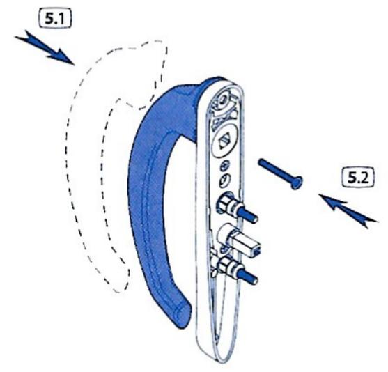
**6** Serrer la vis à l'aide d'un tournevis **Visseuse interdite**
