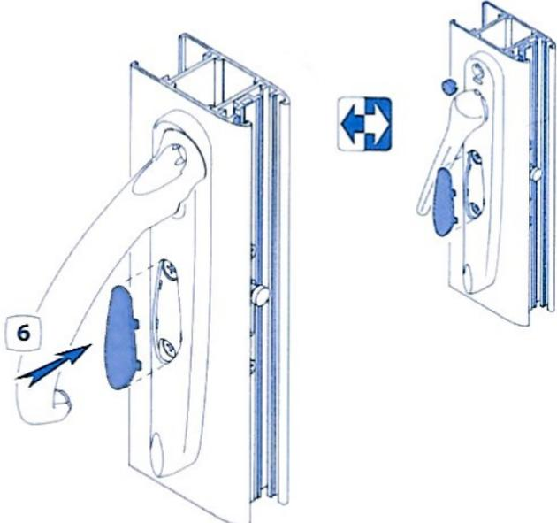
**7** Appuyer sur l'AFM et actionner la béquille
