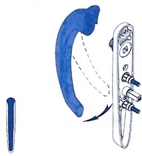
**5** Placer la vis et la béquille sur la platine
