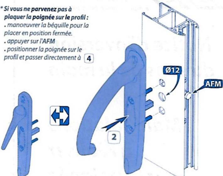
**3** Appuyer sur l'AFM et actionner la béquille
